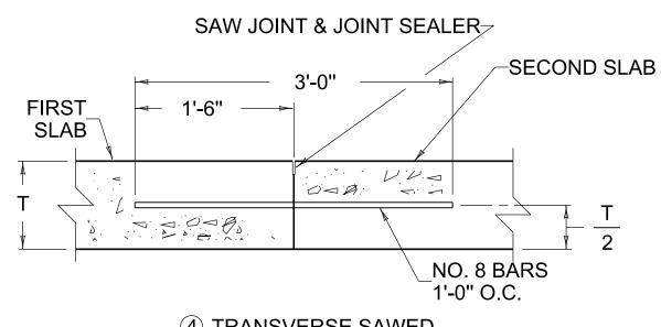
4 TRANSVERSE SAWED CONSTRUCTION JOINT
